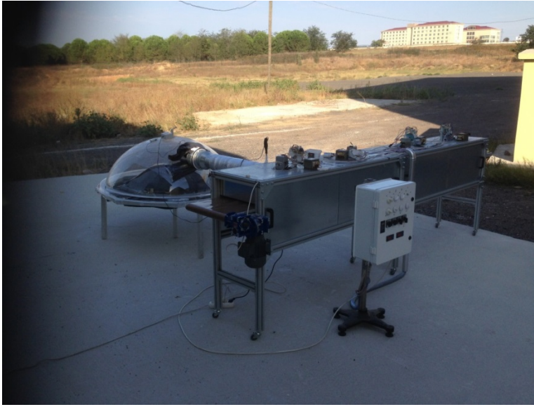
Şekil 3.1. Güneş enerjisi destekli konveyörlü mikrodalga kurutucu
